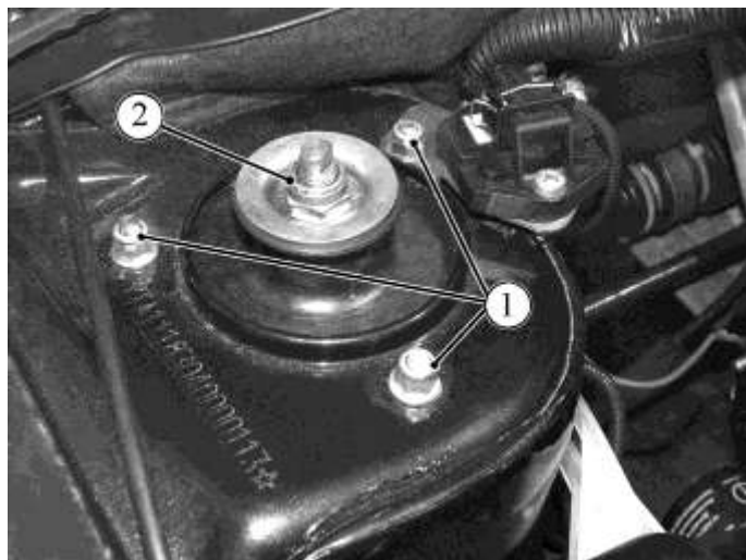
Рисунок 4 – Элементы передней подвески:
